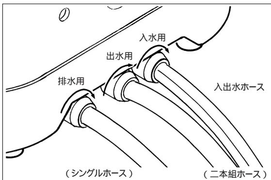
(3) 排水ホースは付属の吸盤に通し固定してください。入出水ホースは2連管になっていますが、接続間違いを防止するために一方のホースには青いラインが印刷されています。接続のときご確認ください。
